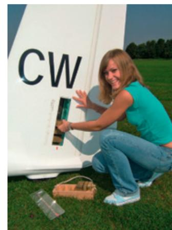
Der Trimmkasten im Seitenleitwerk ist ein Alleinstellungsmerkmal der DG-1001 Familie. Mit ihm kann die Masse der Besatzung optimal ausgeglichen werden. So ermöglicht er nicht nur ein sehr gutes Trudeltraining sondern verbessert auch das Handling und die Leistung im Kurven- als auch im Geradeausflug. Der gesamte Schwerpunktbereich der DG-1001 darf aber auch ohne Verwendung des Trimmkastens genutzt werden.
