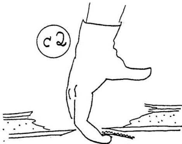
Wenn das Loch groß ist, sodaß die vorgeschriebene Lage der inneren Gewebeschicht nach diesem Verfahren nicht sicher erreicht werden kann, oder der Stützstoff nicht auf einmal eingesetzt werden kann, helfen wir uns durch eine provisorische Arbeitsplattform:
