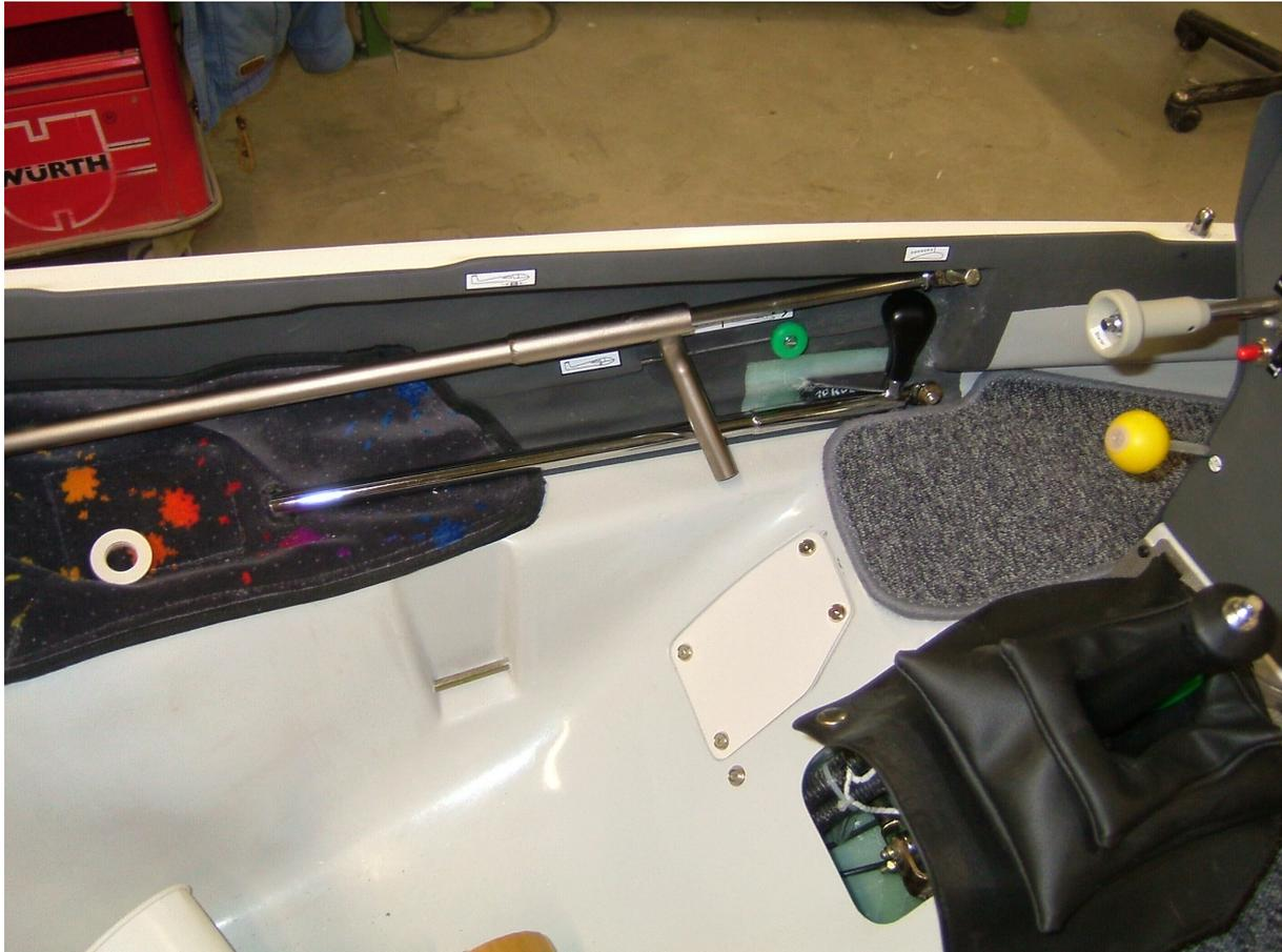
Foto 1: linke Bordwand, Fahrwerk ausgefahren und verriegelt
