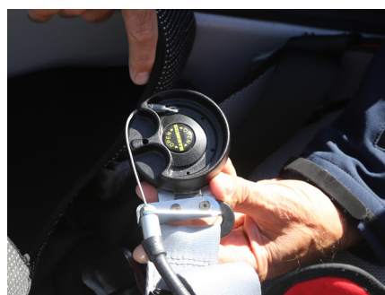
Gasfjeder gør in-flight justering af rygstøtte i forsæde muligt.
