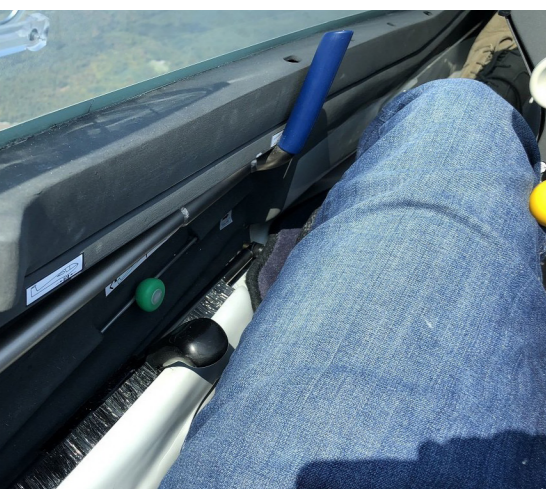
LN-GOL er den første DG-1001 M til at blive monteret med permanent håndstyring af sideror (lille sort håndtag under grønt trimregulering).
