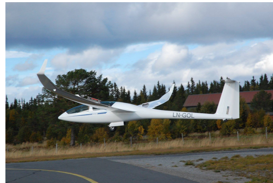
Første landing i klubbens regi. Schempp-Hirth-type luftbremserne giver fin kontrol over glidevinklen.
