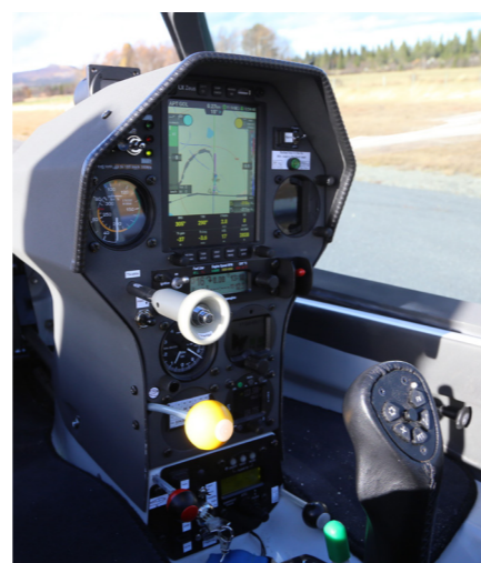
Forsæde: DG's champignon-style instrumentpanel, som kræver, at man løfter højre ben til strækmark-lignende vinkler før man entrerer flyet. Man sidder dog fint, når man har klaret "adgangskravet". Rød udløser nederst er nødudfælding til det elektriske hovedhjul. Hjulet på finnen er i øvrigt fast.
