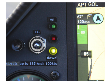
Kontrolpanel for elektrisk understel. Den grønne lampe viser ”down and locked”. LX-instrumentet indikerer i øvrigt en højdevind på 120 km/t! Værsgodt at lande!
