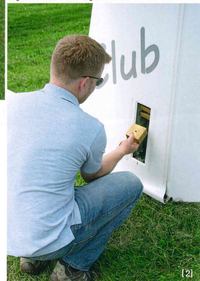
[1] Die Ausgleichsgewichte für unterschiedliche Cockpitbeladungen passen in die Cockpitvorrichtungen und in den Leitwerksschacht. [2] Der Leitwerksschacht kann einfach befüllt werden. Das ist im Flugbetrieb aber nicht ständig erforderlich.
