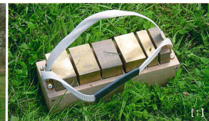
[1] Die Ausgleichsgewichte für unterschiedliche Cockpitbeladungen passen in die Cockpitvorrichtungen und in den Leitwerksschacht. [2] Der Leitwerksschacht kann einfach befüllt werden. Das ist im Flugbetrieb aber nicht ständig erforderlich.
