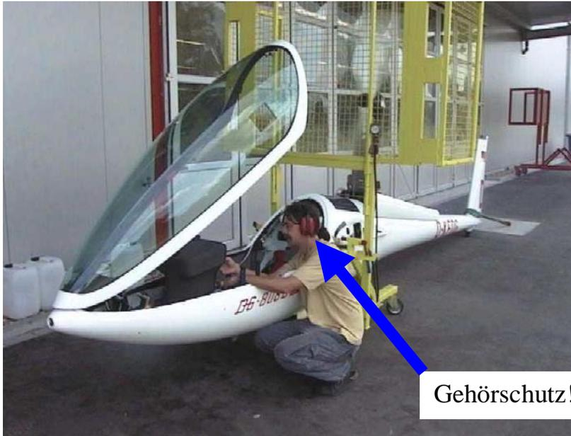
**Warnung:** Motorprobelauf niemals ohne montierte Tragflügel durchführen.
