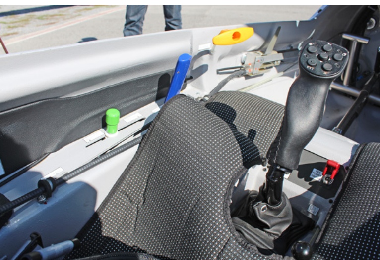
Trimmhebel, Bremsklappen und Klinke bleiben dank sauberer Einarbeitung auch bei den heutigen, engen Rumpf-Querschnitten problemlos erreichbar
