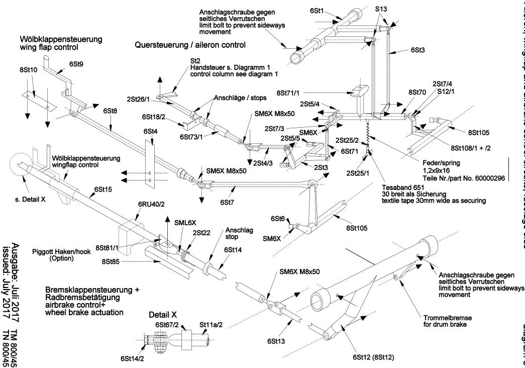
Quer-, Aileron, wingflap and Wölbklappen- und Bremsklappensteuerung im Rumpf DG-800B MW Diagramm airbrake control circuits, fuselage side diagram 3 ω
