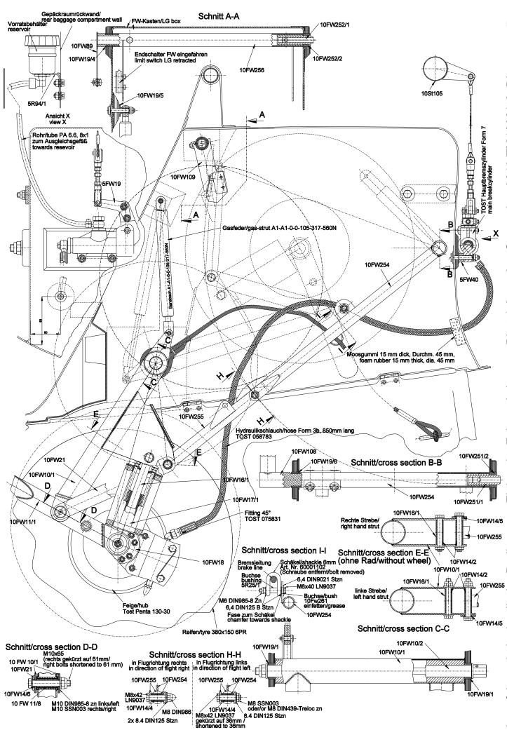
Diagramm 7 diagram 7 TM1000/40 Hauptfahrwerk, hydraulische Radbremse, Einbau im Fahrwerkskasten, Blatt 1 Ausgabe: September 2018 TM1000, Main landing gear, hydraulic wheel brake, installation in the LG box, page 1 issued September 2018 TN1000/40
