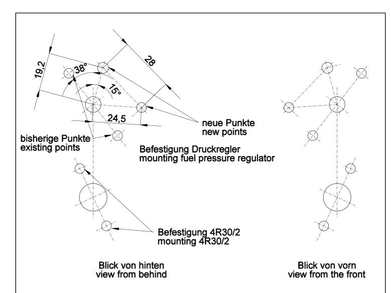
Schablone zum Bohren der Befestigungspunkte für den neuen Druckregler pattern to drill the mounting holes for the new fuel pressure regulator
