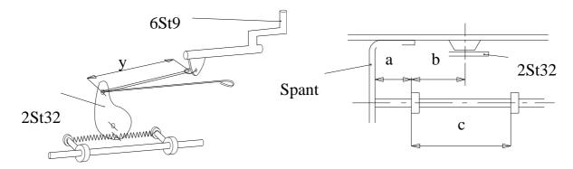
Der Gummizug zwischen Wölbklappenhebel 6St9 und Trimmhebel 2St32 ist auszutauschen, wenn er verschlissen ist oder sich gelängt hat. Die Länge in ungespanntem Zustand y beträgt 110 mm s. Skizze. Der Zug besteht aus Expandergummi, Durchm. 2 mm, 3-fach gelegt.
