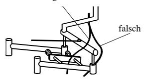
Eine Verlegung außerhalb der Schwingen kann zum Blockieren der Steuerung führen.
