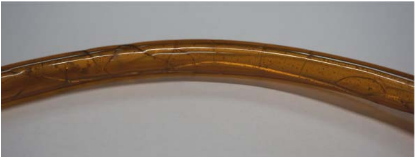
PU Schlauch mit Risslinien, die von innen ausgehen
