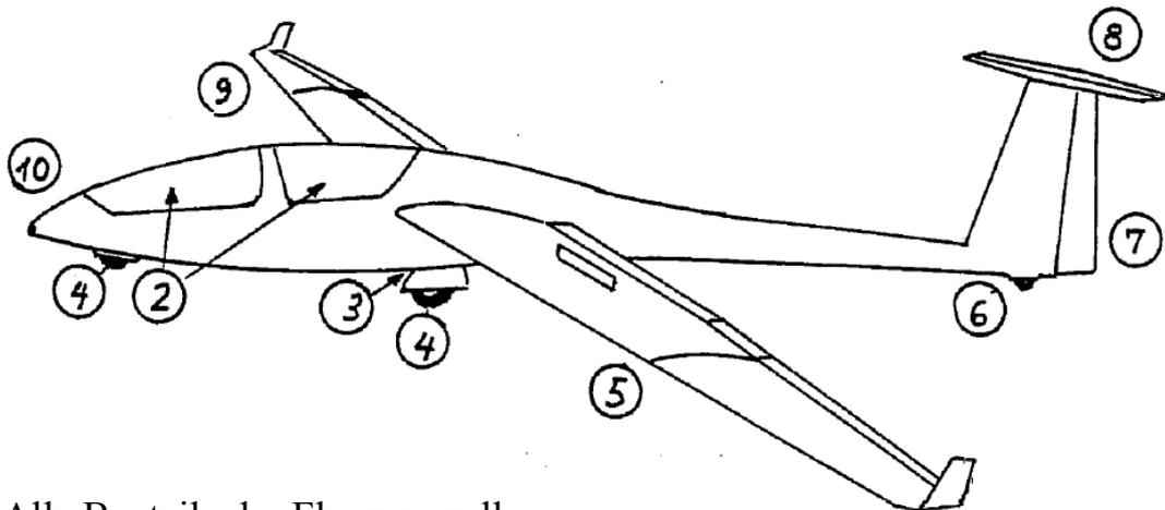
1. Alle Bauteile der Flugzeugzelle
