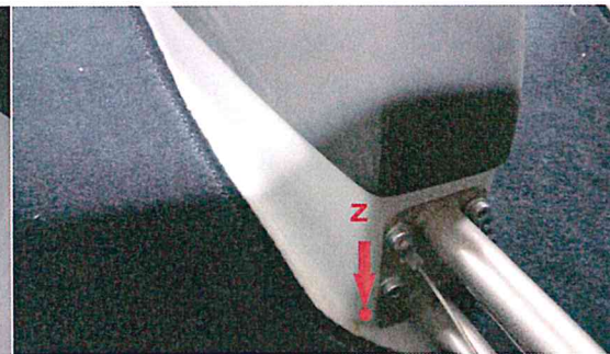
Abbildung 5: Bohrung Z für opt. Kabelführung
