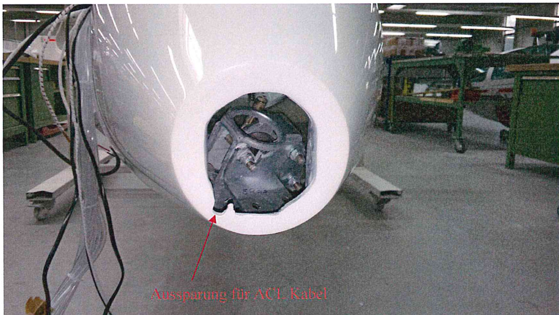
Abbildung 1: Gefinisierte Rumpfnase mit Ausschnitt und Aussparung für BLITZLICHT Kabel
