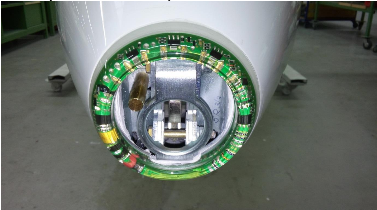
Abbildung 1, Rumpfnase der DG-1000 mit Bugkupplung und BLITZLICHT
