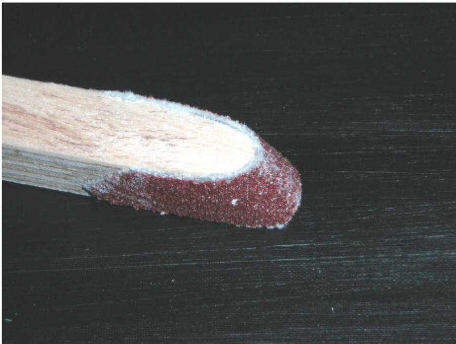
Bild 3-2: Abgeschrägte und verrundete Vierkantholzleiste, mit Schleifpapier beklebt
