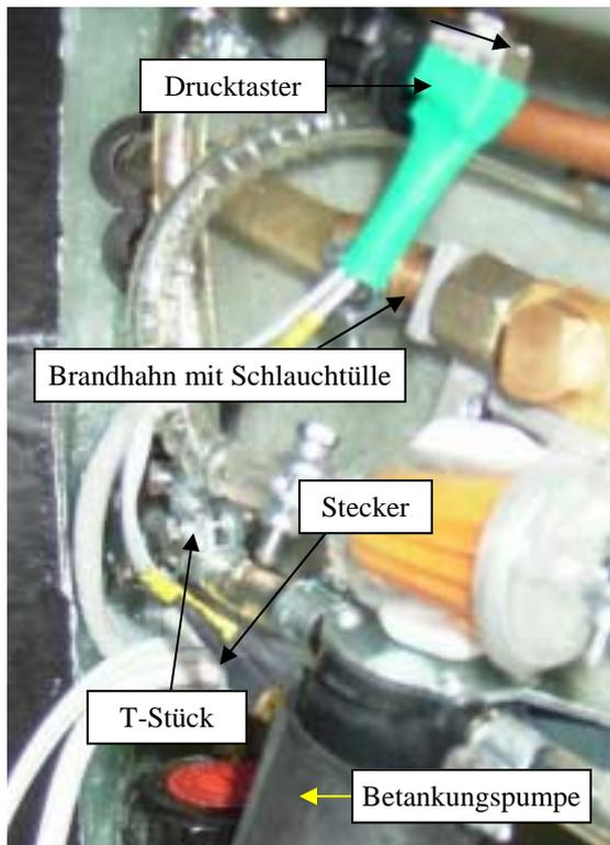
**Abbildung 3** Blickrichtung ist Flugrichtung von Motorraum zum hinteren Hauptspant
