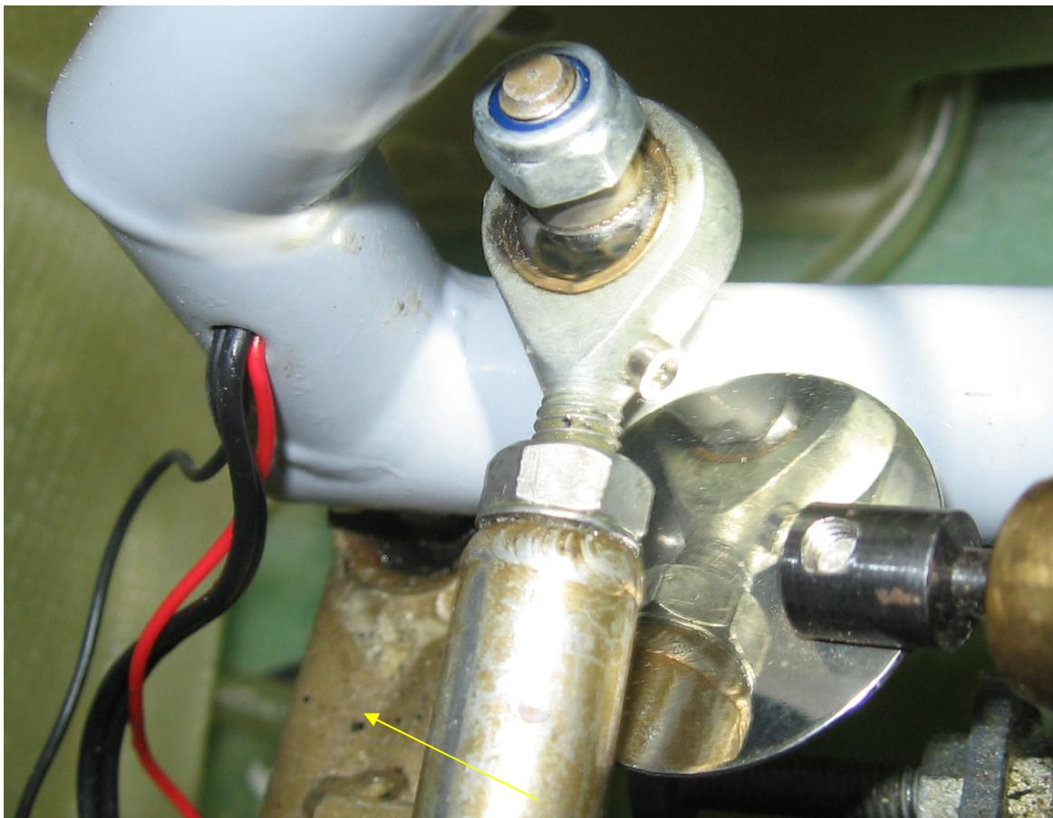
Prüfung mit Spiegel: es ist kein X vorhanden, Gelenkstangenkopf muss ausgetauscht werden.
