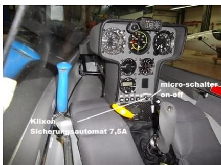
Abbildung 4: Einbau Schalter und Sicherungsautomat
