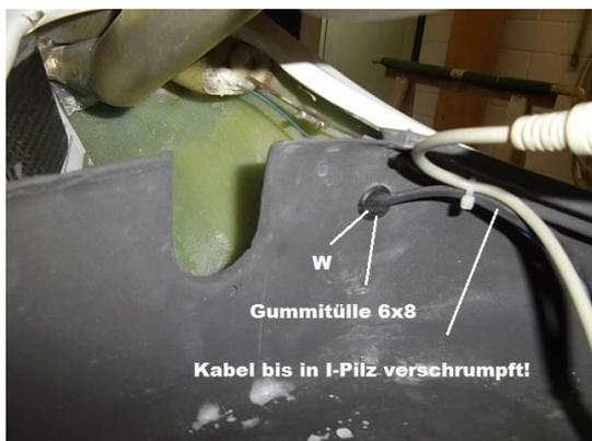
Abbildung 2: Bohrung W für opt. Kabelführung
