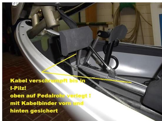
Abbildung 3: opt. Kabelführung zum I-Pilz
